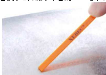
ツール先端を、ワークに対して一定角度をつけて研磨します。
